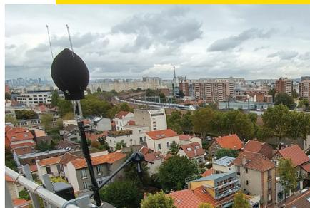
Station de mesure Bruitparif permettant de suivre les nuisances sonores générées par les arrêts des TGV à Malakoff (92).
